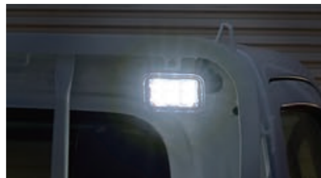
LED大型荷台作業灯 (首振り機構付)
