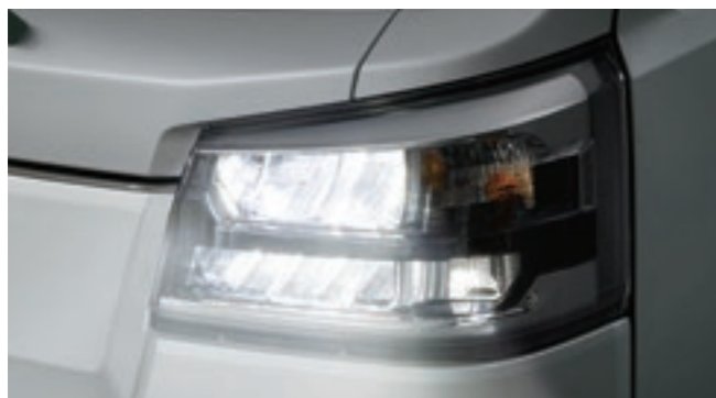
LEDヘッドランプ (ロー/ハイビーム・オートレベリング機能・ LEDクリアランスランプ・オートライト付)
