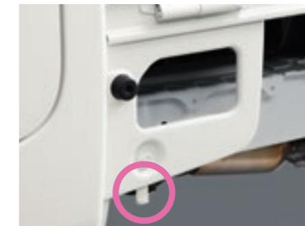
平シートフック2箇所 荷台ステップ/平シートフック 長靴でも足をかけやすい広い開口幅。平シートの固定に便利なフック。
