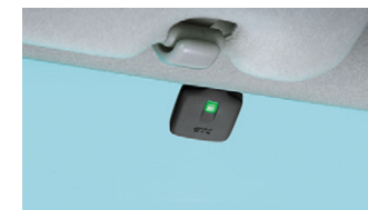
GPS内蔵ETCアンテナ装着例
