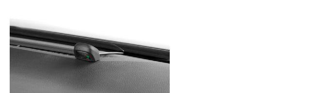
GPS内蔵ETCアンテナ装着例
