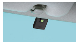
ETCアンテナ装着例
