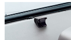
ETCアンテナ装着例
