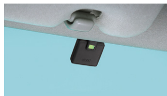
ETCアンテナ装着例
