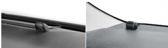
ETCアンテナ装着例
