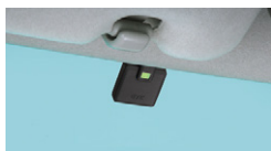
ETCアンテナ装着例
