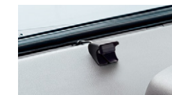
ETCアンテナ装着例
