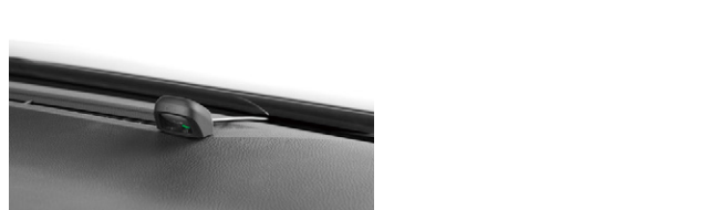
ETCアンテナ装着例
