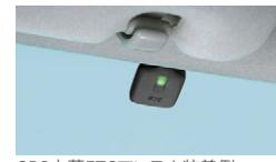
GPS内蔵ETCアンテナ装着例
