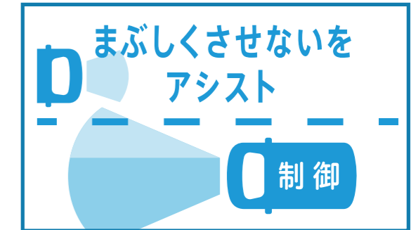
ADB (アダプティブドライビングビーム) 【クルーズターボ、クルーズ (CVT)、デラックス (CVT) にメーカーオプション】
