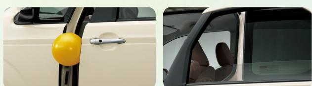
\*2.挟まれる物の形状や挟まれ方によって ●スライドドアを開ける際に窓が開いています、挟み込みを検知できない場合があります。いる場合は、スライドドアの開口範囲を制限して挟み込みを防止します。
