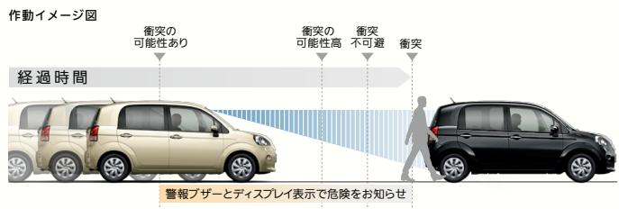
■プリクラッシュセーフティの警報は対車両の場合、自車速度約15km/h～140km/h<sup>※3</sup>、対歩行者(昼間)の場合は自車速度約15km/h～65km/h、自動(被害軽減)ブレーキは対車両の場合は自車速度約10km/h～80km/h、対歩行者(昼間)の場合は自車速度約10km/h～65km/hで作動します。また、道路状況、車両状態、天候状態およびドライバーの操作状態等によっては、作動しない場合があります。詳しくは取扱書をご覧ください。 ■プリクラッシュセーフティはあくまで運転補助機能です。本機能を過信せず、必ずドライバーが責任を持って運転してください。 ■数値は社内測定値。
