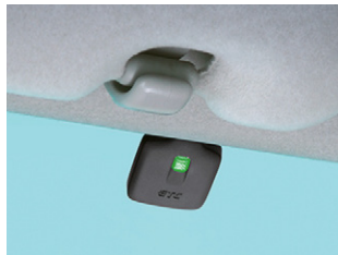
GPS内蔵ETCアンテナ装着例
