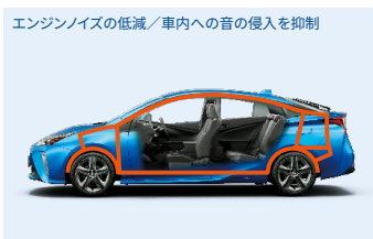
エンジンノイズの低減／車内への音の侵入を抑制
