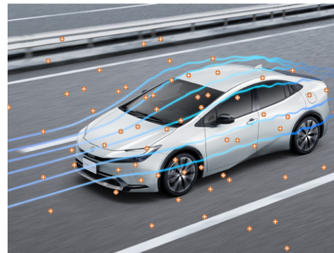
走行中、静電気による空気の乱れが発生。
