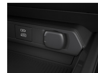
④アクセサリソケット (DC12V・120W/センターコンソール前部1個)
