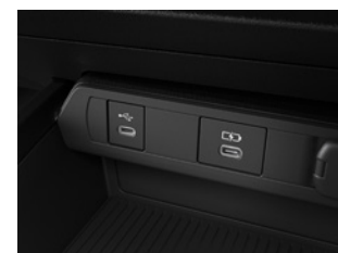
②通信/充電用USB端子 (Type-C/センターコンソール前部1個) ③充電用USB端子 (Type-C/センターコンソール前部1個)
