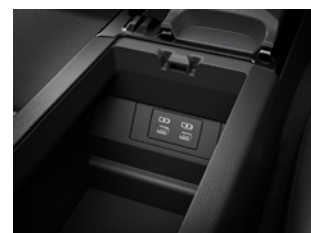
①充電用USB端子 (Type-C/センターコンソールボックス内側2個)
