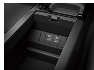
②充電用USB端子 (Type-C/センターコンソールボックス内側2個)
