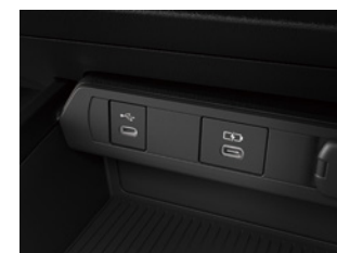
⑤通信/充電用USB端子 (Type-C/センターコンソール前部1個) ④充電用USB端子 (Type-C/センターコンソール前部1個)
