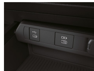
㉛通信/充電用USB端子 (Type-C/センターコンソール前部1個) ㉜充電用USB端子 (Type-C/センターコンソール前部1個)
