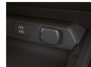
㉝アクセサリソケット (DC12V・120W/センターコンソール前部1個)
