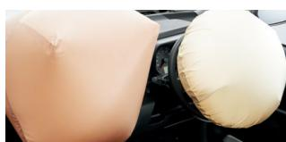
\*9. SRS[乗員保護補助装置]:Supplemental Restraint System ■写真は機能説明のためにSRSエアバッグが作動した状態を再現したもので。 ■SRSエアバッグは、シートベルトを補助する装置です。必ずシートベルトをご着用ください。 ■SRSエアバッグは、衝突の条件によっては作動しない場合があります。 ■チャイルドシート等を助手席に着用するときは、後ろ向きにしないなど、ご注意いただきたいことがあります。必ず取扱書をご覧ください。
