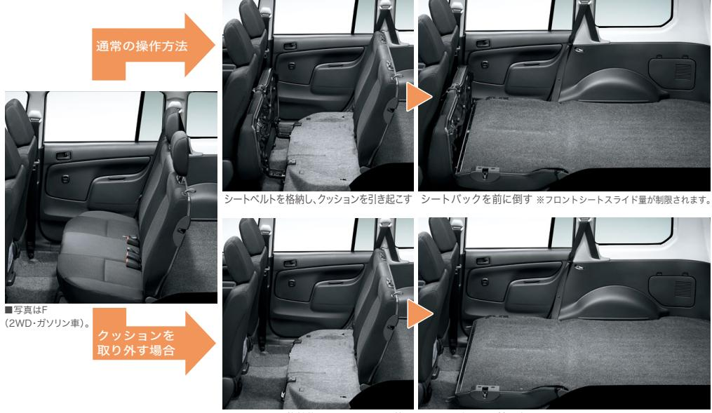
シートベルトを格納し、クッションを引き起こす シートバックを前に倒す ※フロントシートストライド量が制限されます。
