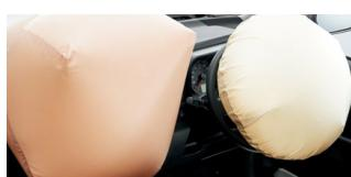
\*9. SRS[乗員保護補助装置]:Supplemental Restraint System ■写真是機能説明のためにSRSエアバッグが作動した状態を再現したもので。 ■SRSエアバッグは、シートベルトを補助する装置です。必ずシートベルトをご着用ください。 ■SRSエアバッグは、衝突の条件によっては作動しない場合があります。 ■チャイルドシート等を助手席に着用するときは、後ろ向きにしないなど、ご注意いただきたいことがあります。必ず取扱書をご覧ください。
