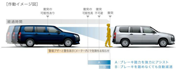
■警報は対車両の場合は自車速度約15km/h~140km/h<sup>1</sup>、対歩行者(昼)の場合は自車速度約15km/h~65km/h、衝突被害軽減ブレーキは対車両の場合は自車速度約10km/h~80km/h、対歩行者(夜)の場合は自車速度約10km/h~65km/hで作動します。また、道路状況、車両状態、天候状態およびドライバーの操作状態等によっては、作動しない場合があります。詳しくは取扱書をご覧ください。■プリクラッシュセーフティはあくまで運転補助機能です。本機能を過信せず、必ずドライバーが責任を持って運転してください。■数値は社内測定値。
