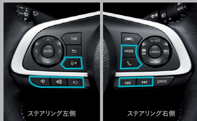
ステアリングスイッチ (オーディオ・ハンズフリー・パノラミックビュー操作) ■写真はZ (ガソリン)。
