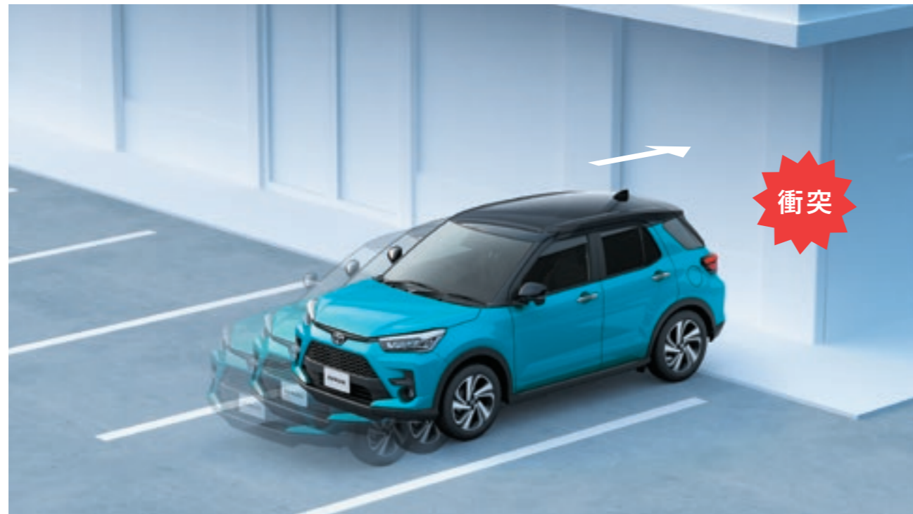
例えば、後退時に衝突した時などアクセルが踏み込まれた状態でシフトを「R」から「D」ポジションへ変更
