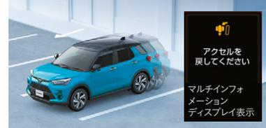
シフト操作時の急発進・急加速を抑制し被害軽減に貢献。
