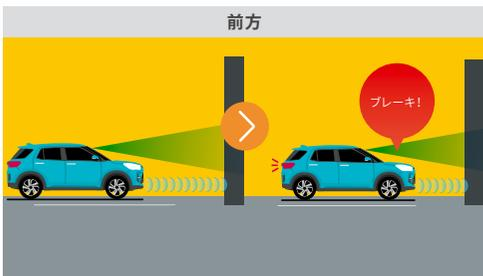
前方約4m以内に障害物等があることをステレオカメラまたは約2～約3m以内に障害物等があることをソナーセンサーが検知している時に、シフトポジションを[D]・[S]・[M](ハイブリッド車は[D]・[B])にしたままブレーキペダルと間違えるなどして必要以上にアクセルペダルを踏み込んだ場合、急発進を抑制します。
