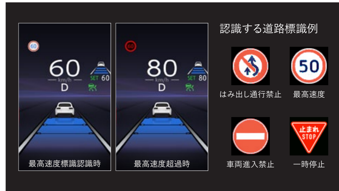
マルチインフォメーションディスプレイ表示 速度規制値を超えた場合などには、表示の反転とブザーでお知らせする機能も。
