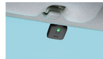
GPS内蔵ETCアンテナ装着例
