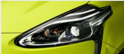
1灯でハイビームとロービームを切り替えられる Bi-Beam LED ヘッドライトを設定。前方を明るく照射しながら、省電力に寄与します。先行車・対向車への眩惑防止に配慮し、車両姿勢の変化に応じて照射軸を一定に保つオートレベリング機能付です。
