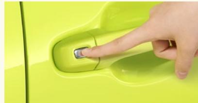
ワンタッチで簡単に開閉できるスイッチを採用。スマートエントリーシステム+プッシュスタートシステム装着車の場合、スマートキーを携帯していればワンタッチスイッチを押すだけで解錠＆ドアオーブンすることもでき、買い物で手荷物を抱えている時などに便利です。挟み込み防止機能<sup>\*1</sup>付。
