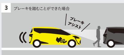
警報ブザーが作動している時にブレーキを踏むと、強力なブレーキアシストが作動します。
