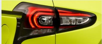
輝度が高く点灯速度の速いLEDランプを採用することで、周囲からの被視認性を高めます。
