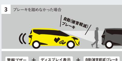
ブレーキを踏めなかった場合でも、自動(被害軽減)<sup>ブレーキ</sup>が作動します。例えば停止車両に対し自車の速度が30km/hの場合や、歩行者(昼間)との速度差が約20km/hの場合に、衝突回避または被害軽減を支援します。
