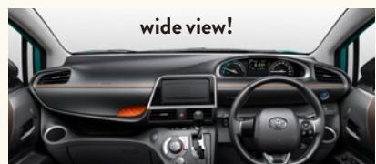
フロントピラーのスリム化とドアミラーの取り付け位置を工夫することで、優れた斜め前方視界を確保。また、最適なポジションで運転できるように、調整範囲の広いチルト機能付ステアリングホイールを全車に標準装備しています。
