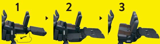
サードシートのロックを解除し、前方へ送り込めばセカンドシートの下にシートがすっきり格納。簡単な操作で奥行きのあるラゲージスペースが出現します。
