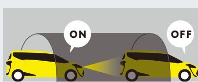
車外の明るさに応じてヘッドライトを自動的に点灯・消灯。夕暮れ時やトンネルの続く山道などで役立ちます。エンジンOFF(ハイブリッドシステムOFF)後、ドアを開けると自動消灯するので、ライトの消し忘れも防止できます。
