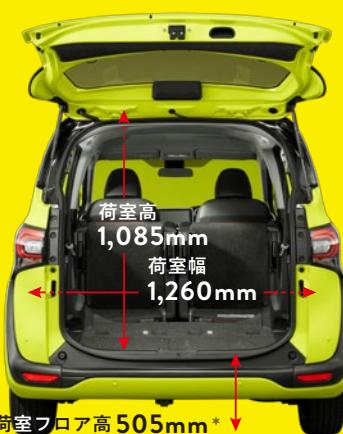
十分な高さと横幅があるスクエアなバックドアの開口部。サードシートを格納すれば、奥行きのあるラゲージベースが出現します。荷室のフロア高も低いので、さまざまな荷物を気軽に積み込みできます。\*数値は2WD車、4WD車(±52mm)。■写真はフラットラゲージモード時。
