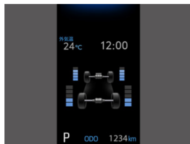
マルチインフォメーションディスプレイ表示例(トルク配分)
