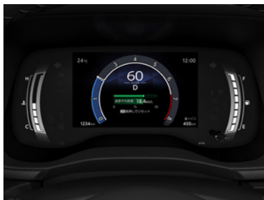
オブティロンメーター+7.0インチTFTカラーマルチインフォメーションディスプレイ
