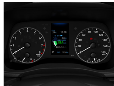
アナログメーター+4.2インチTFTカラーマルチインフォメーションディスプレイ
