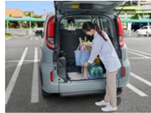
スロープが前に倒れて荷物の出し入れが容易に。
