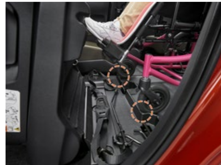
⑤車いすの前輪接地部に、フロアの車止めがあたる所で車いすのブレーキをかけます。
