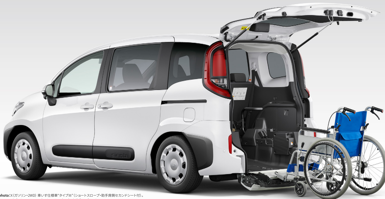
バックドアと連動して展開するショートスロープ
