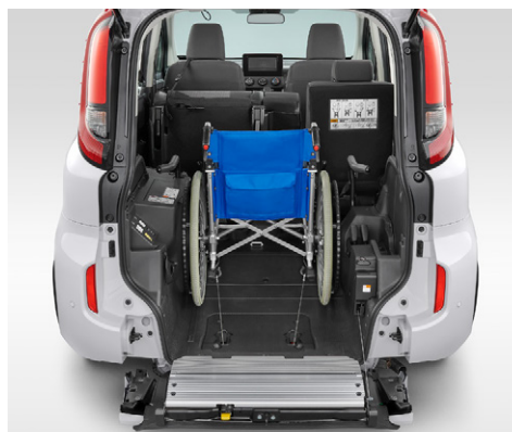
車いす固定状態
