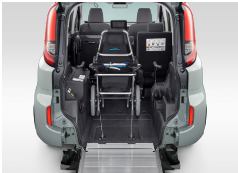
車いす固定状態
