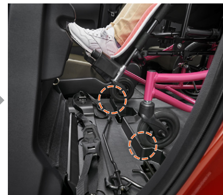
⑤車いすの前輪接地部に、フロアの車止めがあたる所で車いすのブレーキをかけます。
