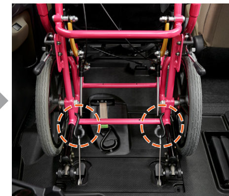
⑥車いす固定装置(1.5列目用)のフックを取り出し、車いすの後部フレーム(左右2か所)に掛けます。
