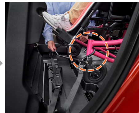
⑨運転席に戻り、前輪固定フックを掛けます。(左右2か所)
