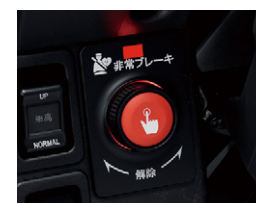
ドライバー席スイッチ (内蔵ランプが点灯) / 解除スイッチ
