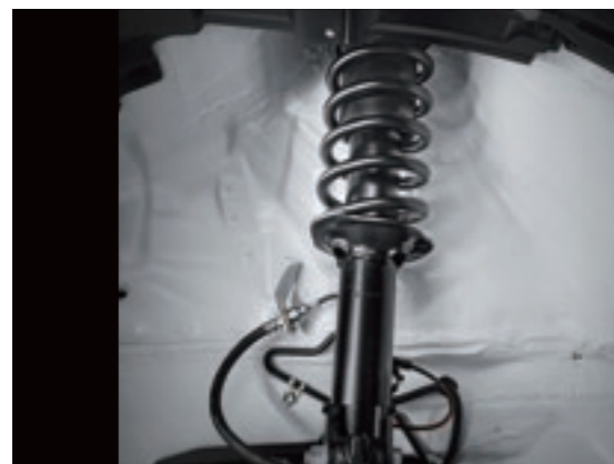
マクファーソンストラット式 フロントコイルサスペンション
