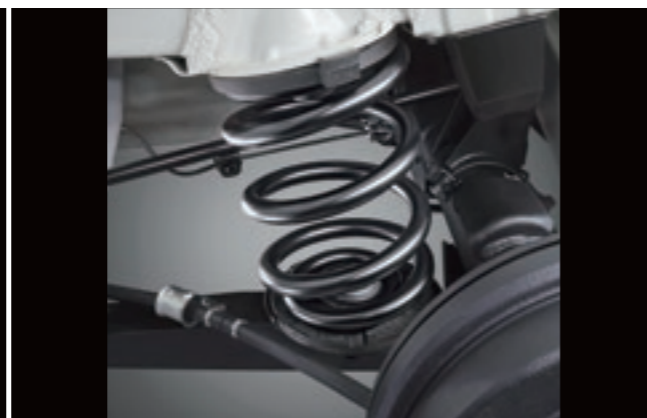
トレーリングリンク式 リヤコイルサスペンション
