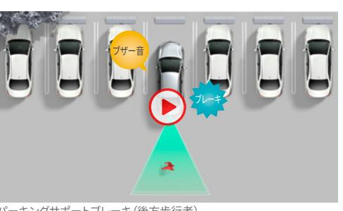
車両周囲の静止物を検知して、衝突被害の軽減に寄与。
