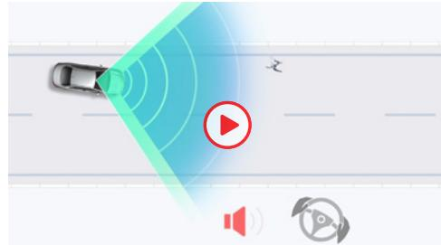
**ドライバーによる回避操舵をきっかけに操舵と車線逸脱抑制をサポート。**
