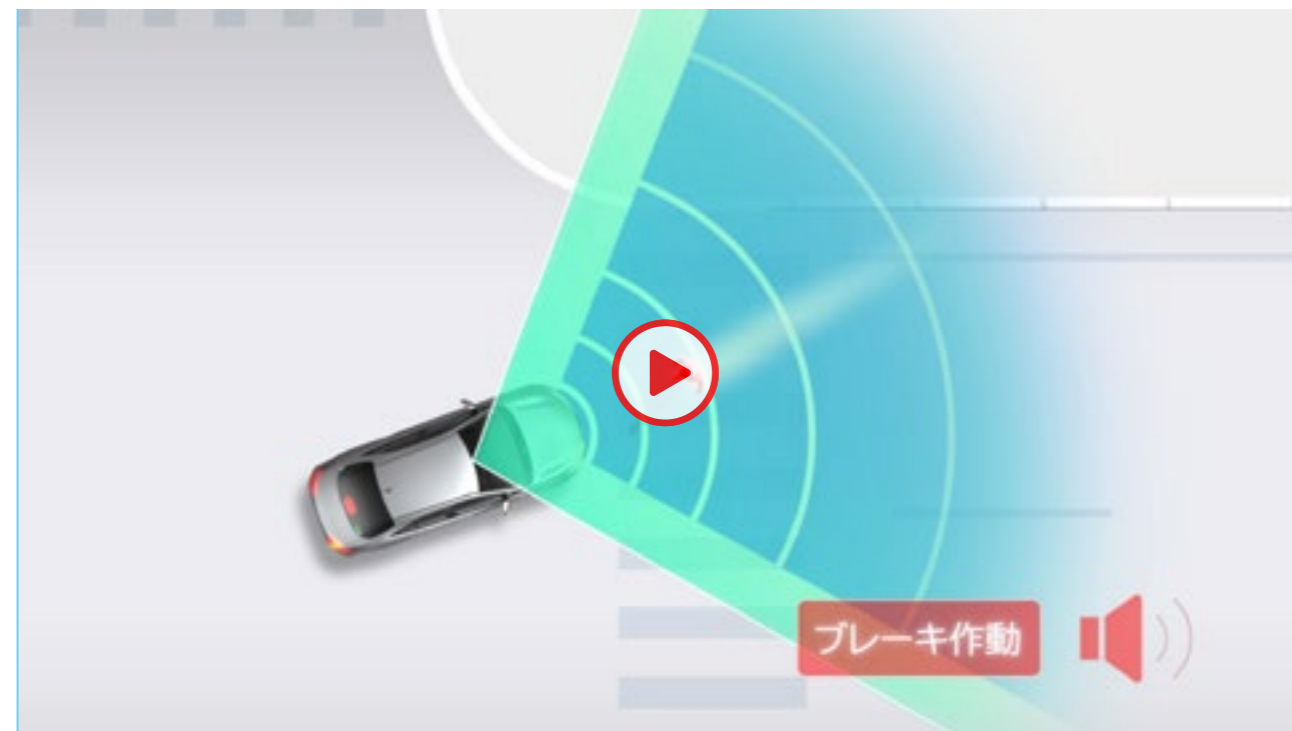
[自車右左折時、対向方向から横断してきた歩行者や自転車運転者も検知。]
