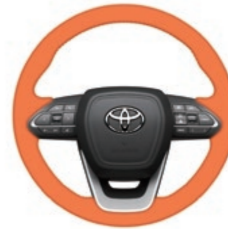
オレンジは、ヒーター加温箇所
