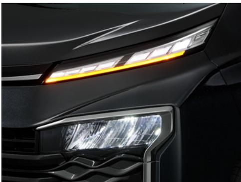
リフレクター式LEDヘッドランプ(マニュアルレベリング機能付)+LEDクリアランスランプ+LEDターンランプ
