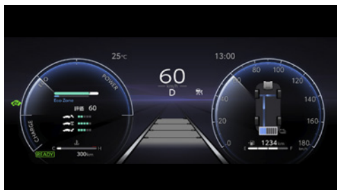
12.3インチTFTカラーメーター＋マルチインフォメーションディスプレイ (メーター照度コントロール付) [S-Zに標準装備]
