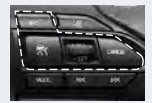
レーダークルーズコントロール/車間距離制御スイッチ
