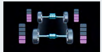
マルチインフォメーションディスプレイ内の 前後輪トルク配分量表示
