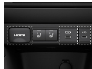
①HDMI入力端子 ②充電用USB端子 (Type-C) ③USB入力 (動画・音楽再生/給電 [Type-C]) [①・②はZ、G、Uに標準装備。Xにメーカーオプション]
