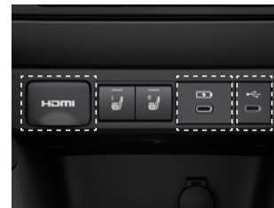
⑨HDMI入力端子 ⑩充電用USB端子 (Type-C) ⑪USB入力 (動画・音楽再生/給電 [Type-C])
