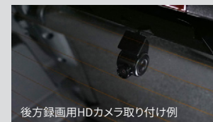
後方録画用HDカメラ取り付け例
