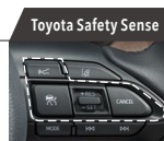
レーダークルーズコントロール/車間距離切替スイッチ
