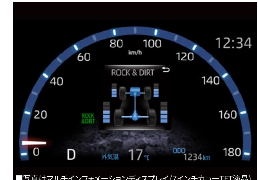
■写真はマルチインフォメーションディスプレイ(7インチカラーTFT液晶)。
