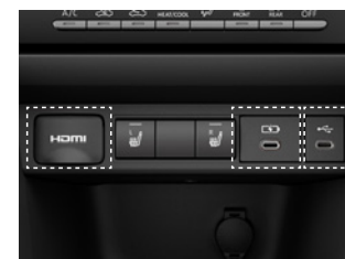
Ⓖ HDMI入力端子 Ⓖ 充電用USB端子 (Type-C) Ⓖ USB入力 (動画・音楽再生/給電 [Type-C]) [ⒼⒼはGR SPORT、Z“Adventure”、Z、G、U に標準装備。Xにメーカーオプション]
