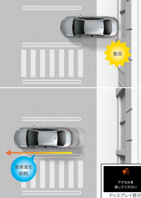
【急アクセル時加速抑制作動時】
