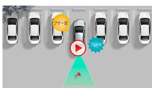
車両周囲の静止物を検知して、衝突被害の軽減に寄与。
