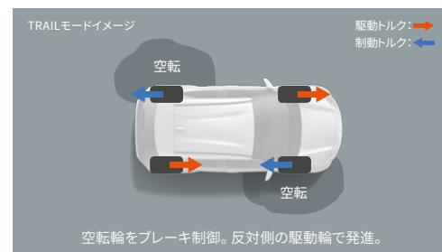
空転輪をブレーキ制御。反対側の駆動輪で発進。
