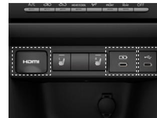
⑭HDMI入力端子 ⑮充電用USB端子 (Type-C) ⑯USB入力 (動画・音楽再生/給電 [Type-C])
