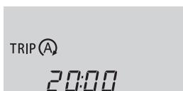
リセット後のアイドリングストップ時間 (Stop & Start システムによるエンジン停止時間) を通算で表示します。
