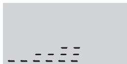
車幅灯が点灯しているとき、メーター照度調整表示に切りかえることができます。
