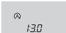
エンジン始動後のアイドリングストップ時間 (Stop & Start システムによるエンジン停止時間) を通算で表示します。
