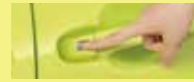
ワンタッチスイッチ付 助手席側パワースライドドア (狭み込み防止機能付)
