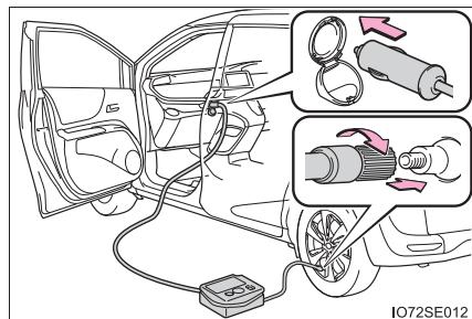
**[27] コンプレッサーのスイッチを約 5 秒間 “ON” にし、“OFF” にして空気圧を確認する**
