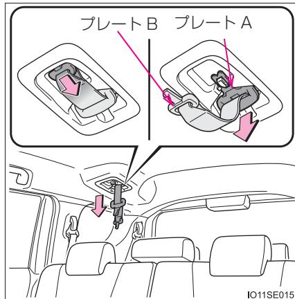
② ベルトを固定するには、プレートB、プレートAの順に“カチッ”と音がするまでプレートをバックルに挿し込む
