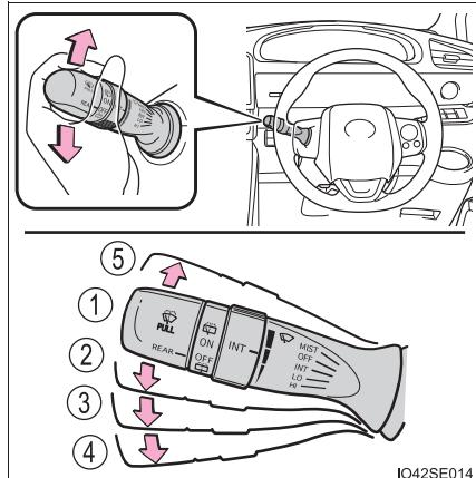
間欠作動を選択しているとき、間欠作動の作動頻度を調整することができます。
