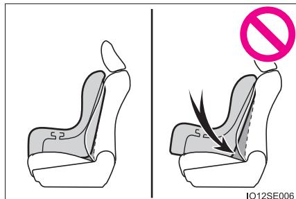
セカンドシート：背もたれを直立状態から8段目の位置に調整してください。前向きにチャイルドシートを取り付けるときに、背もたれとチャイルドシートの間にすき間がある場合は、背もたれとチャイルドシートのすき間が少なくなるように背もたれを調整してください。
