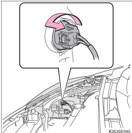
**2** 電球を取りはずす
