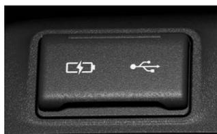
●充電用USB端子(Type-C)1個・通信用USB端子(Type-A)1個[シフトサイドポケット前方]
