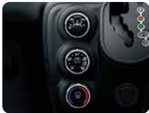
マニュアルエアコン&ダイヤル式 ヒーターコントロールパネル (メッキリング付)
